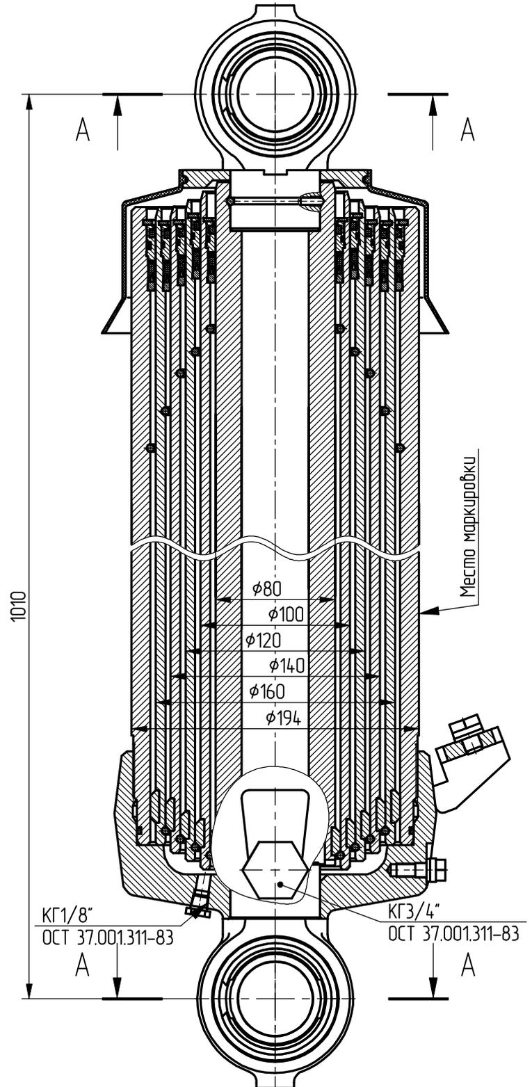
Применяемость: гидроцилиндр подъема платформы автомобилей семейства МАЗ-55165.
