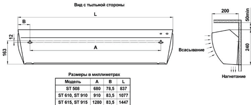
Рис. 2 Габаритные и установочные размеры
